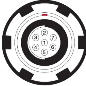
**Figura A-2. Connettore RS232 seriale**
