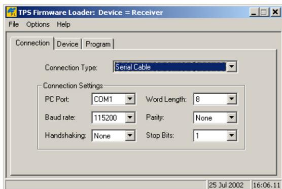
**Figura 5-18. Schermata principale di FLoader**
