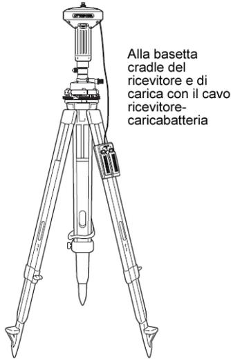
**Figura 2-17. Collegamento della basetta cradle di carica e del ricevitore**
