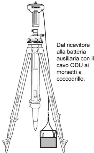
**Figura 2-18. Collegamento di una batteria ausiliaria al ricevitore**
