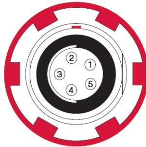
Figura A-1. Connettore di alimentazione
